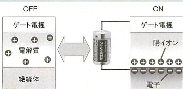
電解質に電圧をかけ、陽イオンを絶縁体表面に押しつけることで、絶縁体の表面に電子が誘起され超伝導になる。本研究では絶縁体としてチタン酸ストロンチウム単結晶、電解質として過塩素酸カリウムのポリエチレンオキシド溶液、ゲート電極として白金線を用いた。
