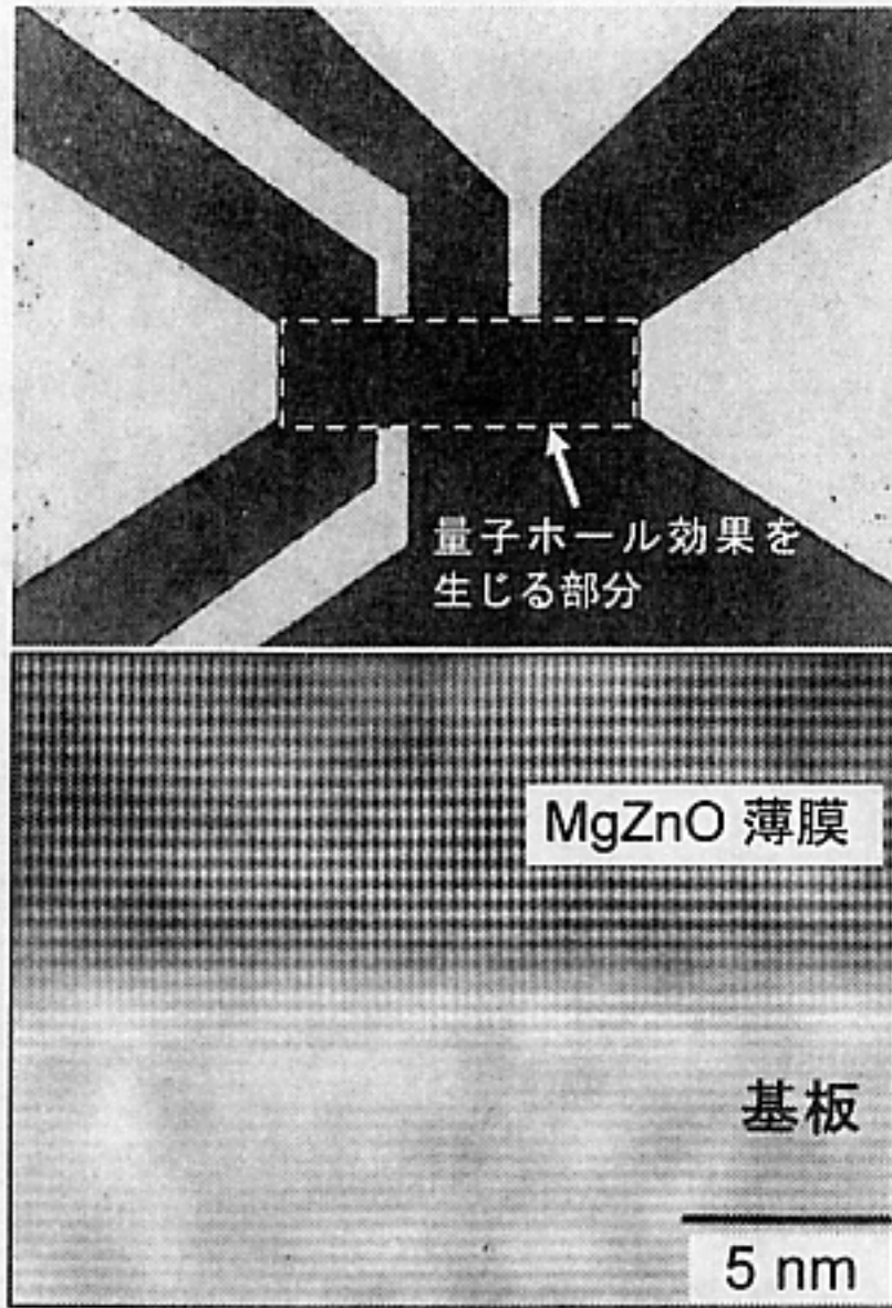
①量子ホール素子の写真、②透過電子顕微鏡写真（東北大多元研進藤教授提供）
